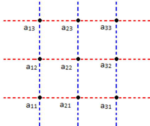
Figura 5: Ilustração esquemática da perturbação na rede quadrada. As linhas tracejadas de ambas as cores representam intensidades de hopping iguais a t .
