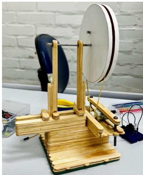
Figura 1: Gerador de corrente contínua.
