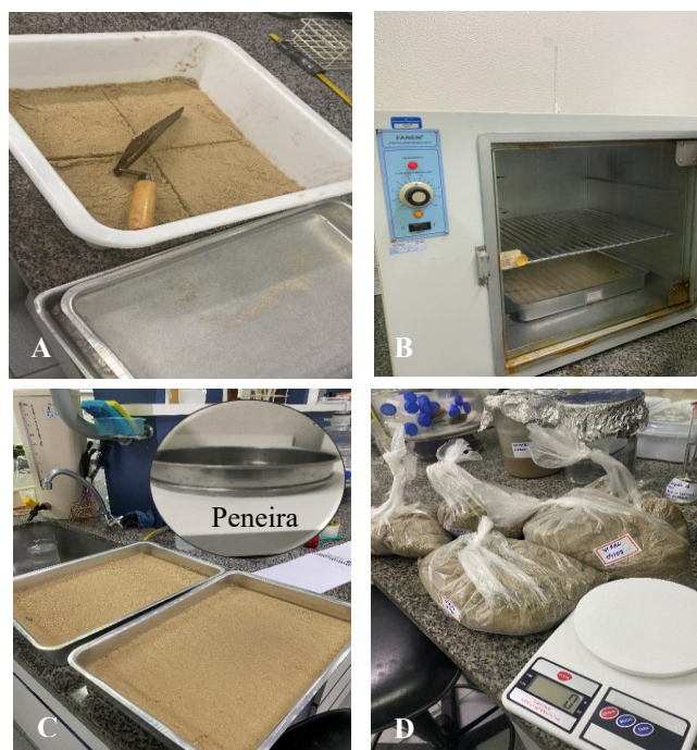
Figura 4: Sequência metodológica da preparação inicial das amostras de areia. A - Quarteamento; B - secagem em estufa à 60°C; C - Peneiramento; D - Pesagem (500 g).
