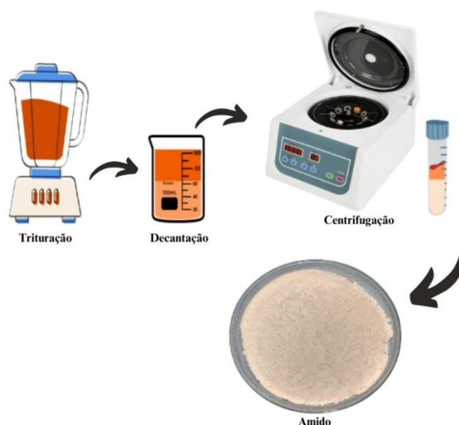
Figura 2: Esquema de representação do processo de obtenção do amido.
