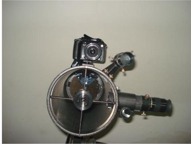
Figura 4: Câmera montada em paralelo com o telescópio.
