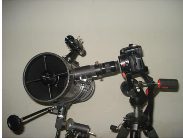
*Figura 7: Sistema de projeção afocal usando tripé.*
