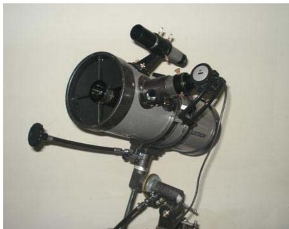
Figura 6: Webcam acoplada ao telescópio.
