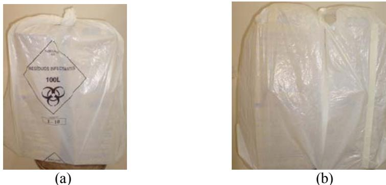
Figura 1 – Simulador (*Fantoma*) de rejeitos radioativos para descarte (a)  $^{99m}\text{Tc}$  e (b)  $^{131}\text{I}$ .
