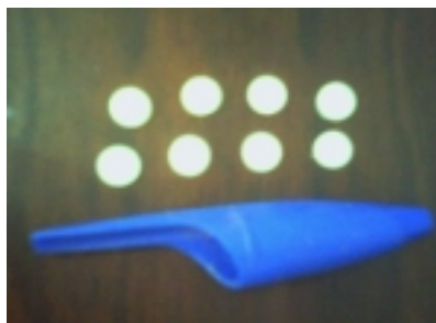
Figura 1 - Detectores TL de CaSO 4 : Dy.
