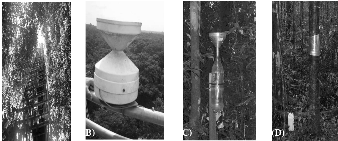
Figura 1 - Instrumentos utilizados Para análise da precipitação em uma parcela de um hectare no interior da FLONA de Caxiuanã, no município de Melgaço, Pará, em 2004. (A) Torre micrometeorológica. (B) Pluviógrafo instalado no topo da torre. (C) Pluviômetro artesanal para medir a
