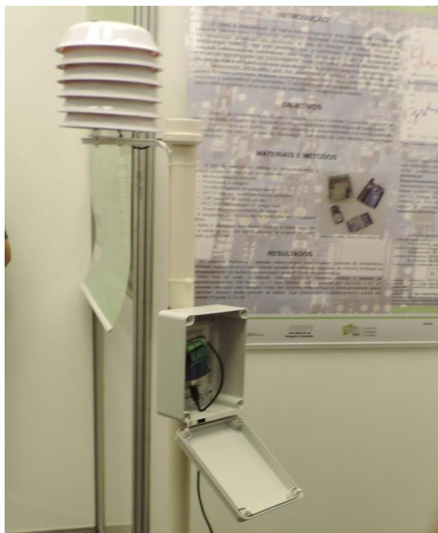
Figura 10: Abrigo meteorológico desenvolvido com materiais alternativos.
