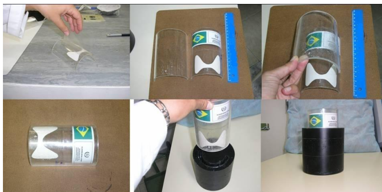
Figura 1: Simulador de tireoide-pescoço produzido no Laboratório de Monitoração In Vivo do IRD
