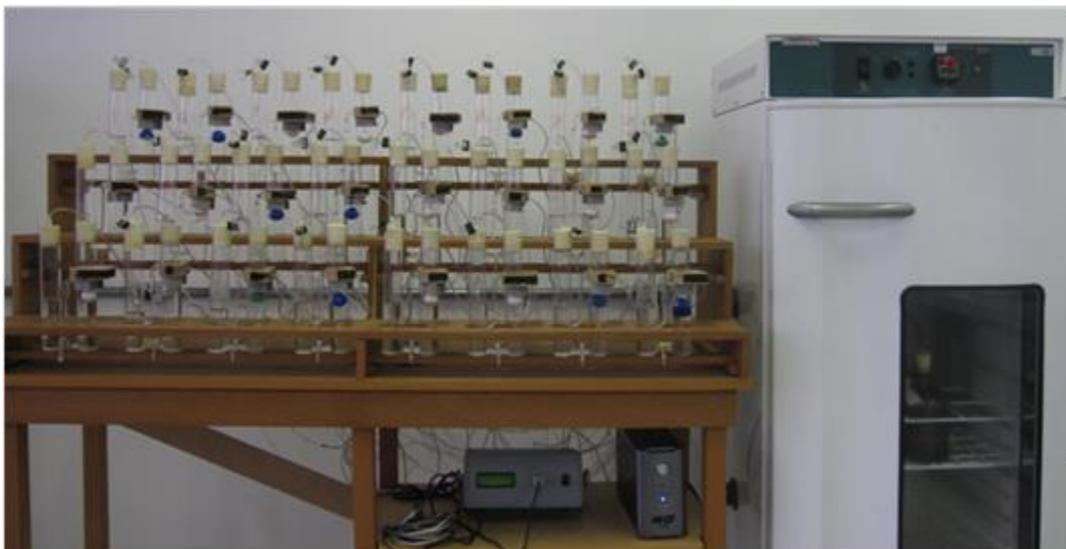
Figura 2: Sistema automatizado de medição de biogás acoplado a incubadora bacteriológica.
