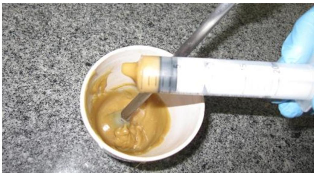
*Figura 1: Borra de glicerina fundida em chapa aquecedora para viabilizar a aplicação.*
