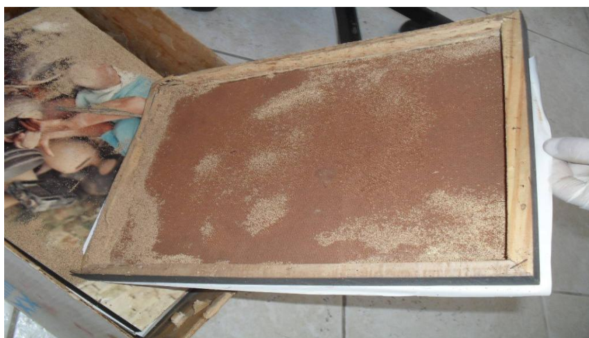
Figura 1: Sinais de infestação de cupins de madeira seca, caracterizados pelos grânulos fecais em uma moldura de um dos quadros, pertencente ao acervo do Museu do Homem Sergipano, Aracaju, SE,
